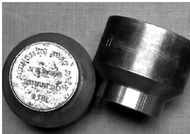
2. irudia. 1875an txanponak egiteko erabilitako trokela 42 .
