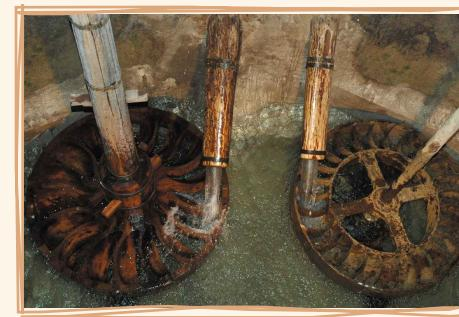
Las piedras que molían maíz y su correspondiente turbina de hierro, así como las destinadas al trigo, y también el pescante para cambiar las piedras, provienen de Narbaizabolu-Goikoa, de Bergara. La turbina de madera, que estaba estropeada en el mencionado molino, ha sido reconstruida en madera de haya, como réplica de la original.
